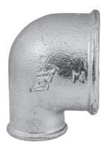
As conexões galvanizadas MECH / Segurimax são produzidas através da fundição de ferro maleável preto, especificado na norma ABNT NBR 6590 e galvanizadas à fogo através de zincagem por imersão a quente conforme ABNT NBR 6323, inspecionadas em conformidade com as normas ABNT NBR 6943:2000, ISO 49 e EN 10242.
